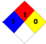
Identificación de riesgos de materiales según NCh 1411
